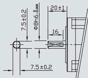
■ CM2-□-60A10C / CM2-□-60A20C / CM2-□-60A40C 外形寸法 (単位:mm)
