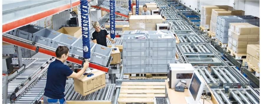
員工生產力與工作場所的人體工學設計密不可分，尤其是員工在手動搬運重物時需要外部助力。SCHMALZ真空搬運系統讓一切變得可行。我們的真空搬運系統直觀、簡便，可以幫助減輕反覆搬運引起的身體損傷。
