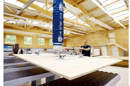
我們的真空搬運裝置是為了有效支援手動搬運任務而設計的。Jumbo真空搬運裝置對於機台上料、運輸和分揀來說都是理想的幫手。它可以在符合人體工學的情況下，精確且快速地搬動重達300kg的箱子、袋子或木板。
