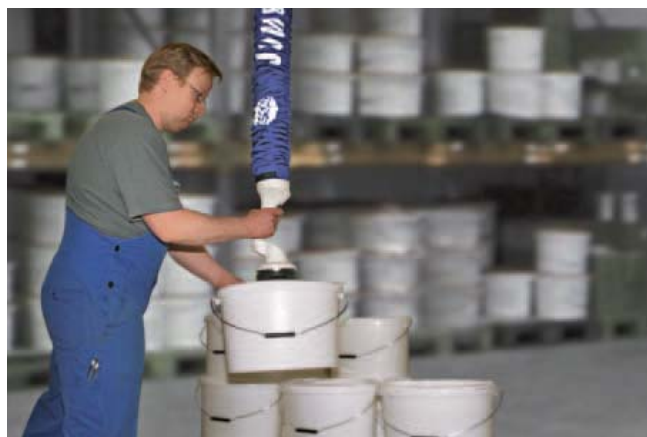
JumboFlex, 负载35kg, 配有圆形吸盘, 用于搬运原料桶
