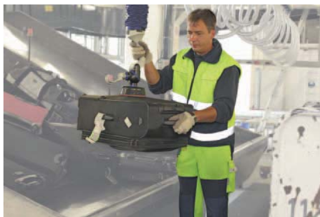
JumboFlex, 负载35kg, 配有吸盘和吊钩交替式夹具, 用于机场行李搬运
