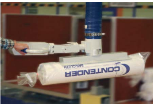
JumboErgo, 负载45 kg, 用于搬运塑料膜包裹的纺织物卷材
