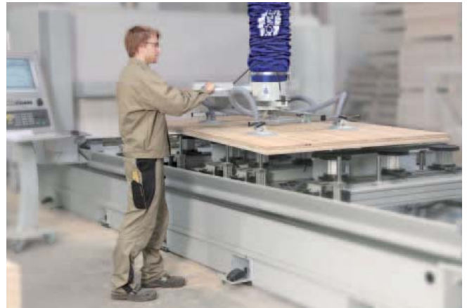
JumboErgo, 负载85 kg, 多个真空吸盘, 用于CNC加工中心的工件上下料
