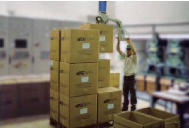
JumboErgo, 负载45 kg, 配有弯曲手柄, 用于吸取或卸下较高位置的工件, 可将工件堆垛至2.5米的高度
