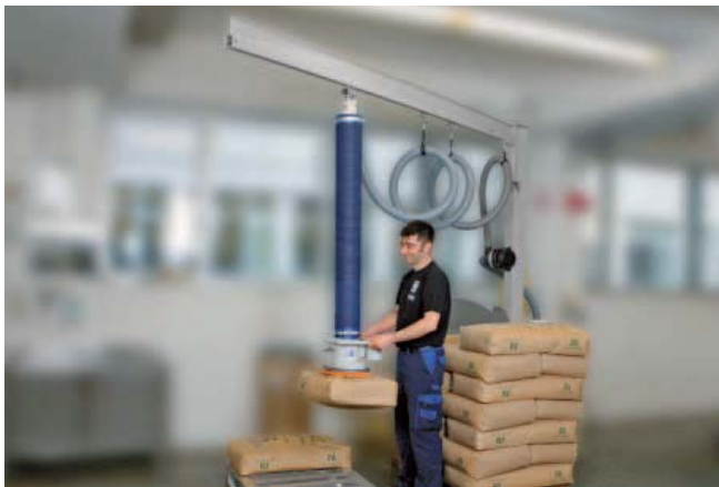
立柱悬臂式轨道系统，平顶式结构，配有不锈钢轨道，负载 85 kg，悬臂长 3.5 m
