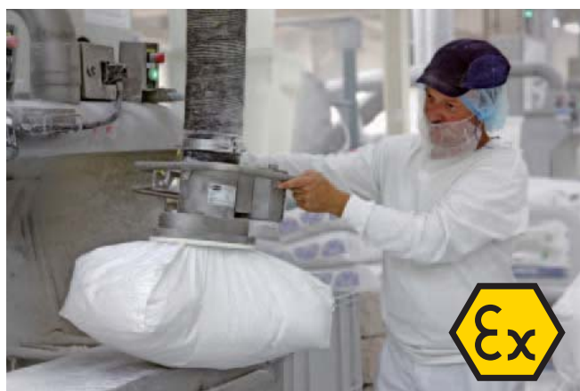
JumboSprint, 负载65 kg, 袋装工件吸盘, 用于防爆领域, 符合ATEX标准
