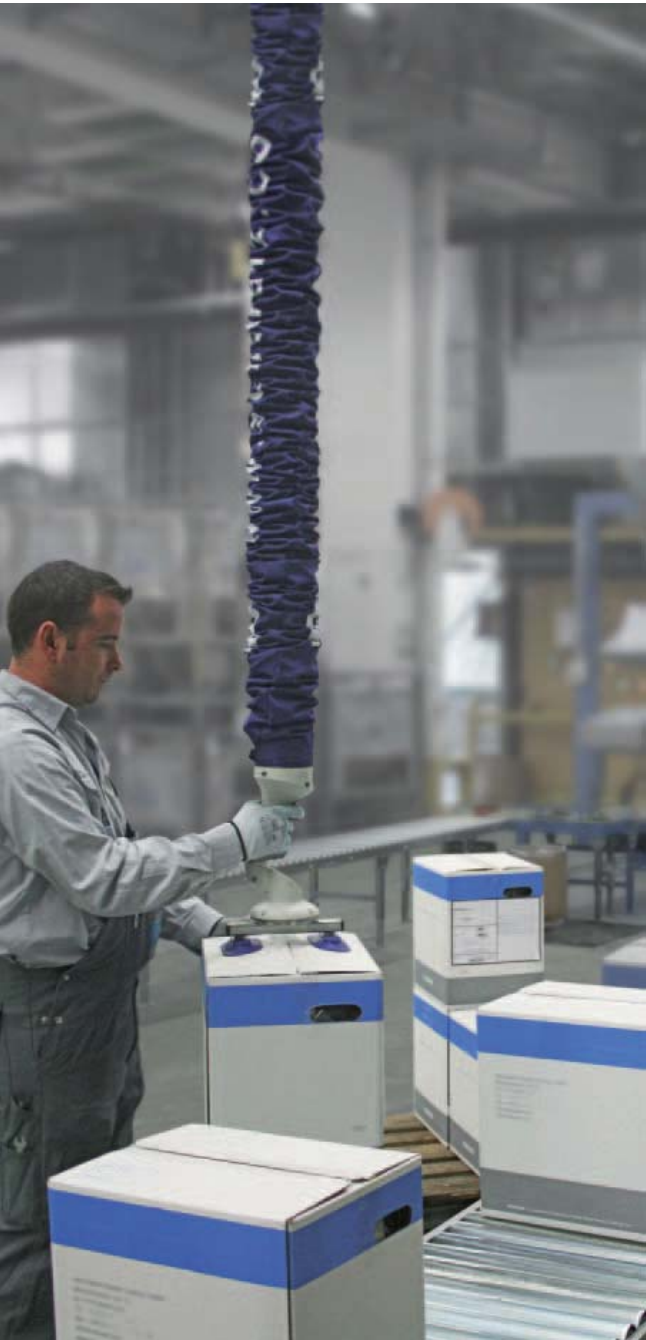
JumboFlex，最大负载35kg，配有双吸盘，用于搬运纸箱
