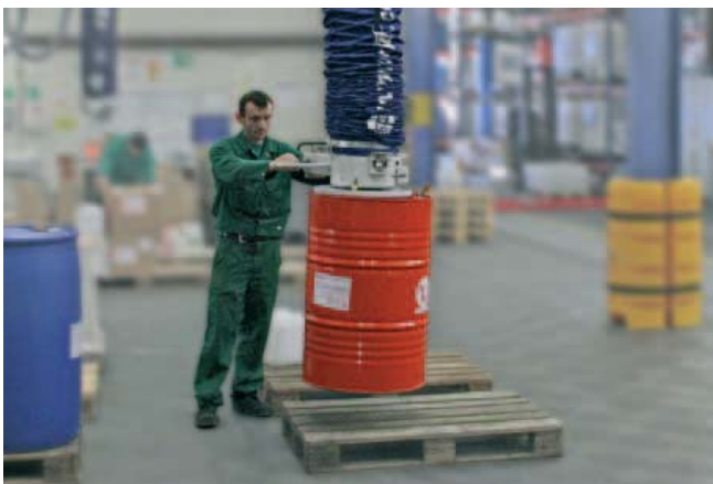
JumboErgo，负载300kg，配有圆形吸盘，用于搬运化工桶
