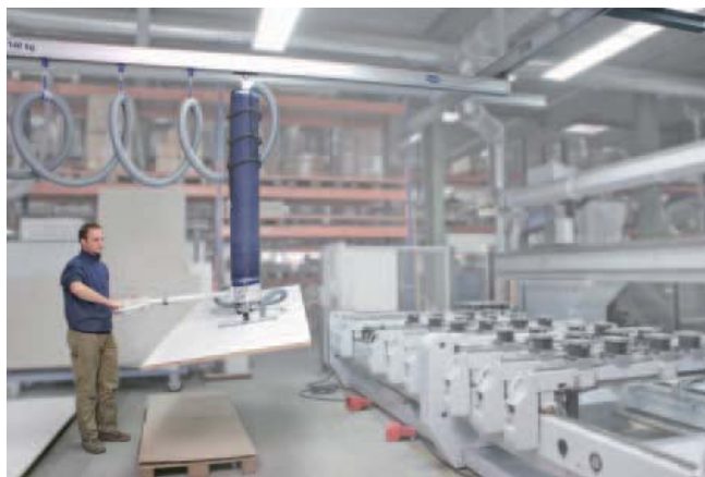
桥式单横梁铝合金轨道系统，负载140 kg
