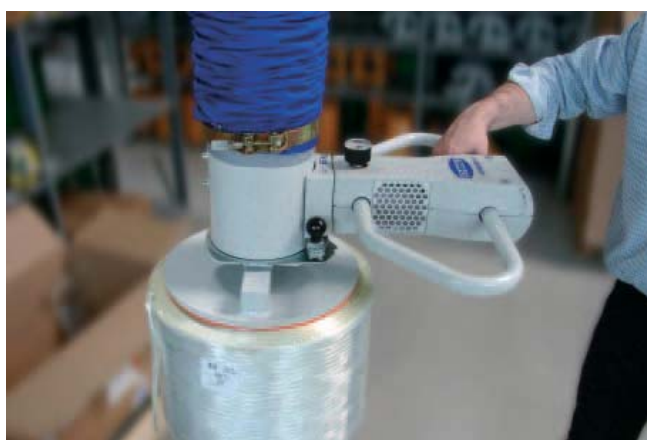
JumboErgo, 负载65 kg, 圆形吸盘, 用于搬运成卷塑料膜
