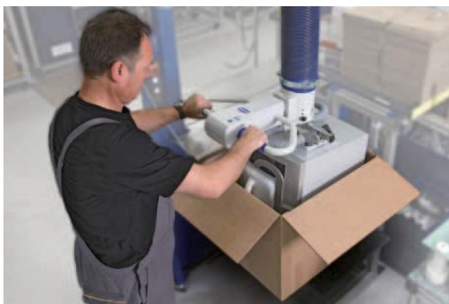
JumboSprint，负载45kg，配有双吸盘，用于货物装箱及搬运密封好的纸箱
