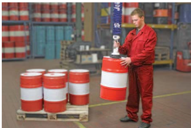
JumboFlex, 负载35kg, 配有圆形吸盘, 用于搬运化工桶
