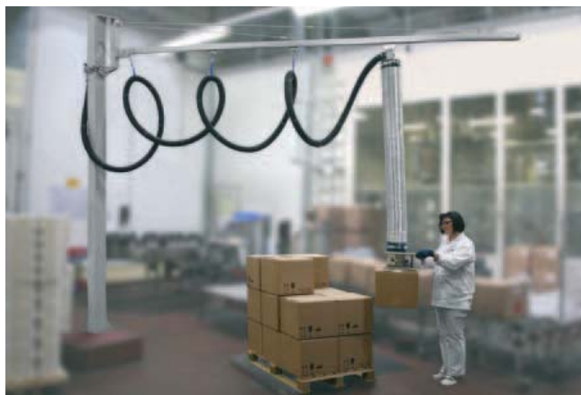
JumboSprint，负载45kg，配有单吸盘，用于防爆领域搬运纸箱包装工件，符合ATEX标准
