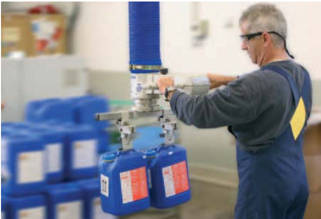
JumboErgo, 负载45 kg, 机械式吊钩, 用于搬运桶装工件
