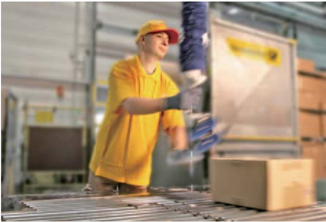
JumboFlex, 负载35 kg, 双吸盘, 用于搬运包裹、仓储和分拣设备的上料 (详见第14页)
