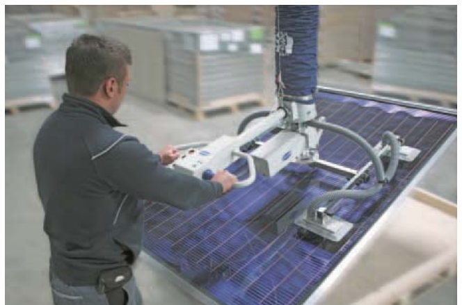
JumboErgo, 负载70 kg, 配有气动翻转单元, 用于搬运太阳能组件
