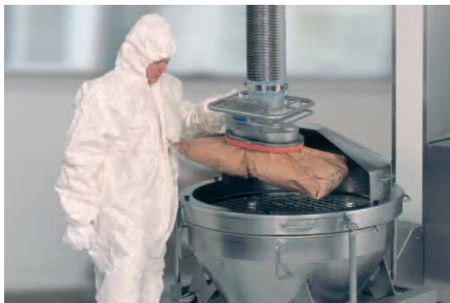
JumboSprint，负载65kg，配有袋装工件吸盘，用于防爆领域搬运袋类包装工件，符合ATEX标准
