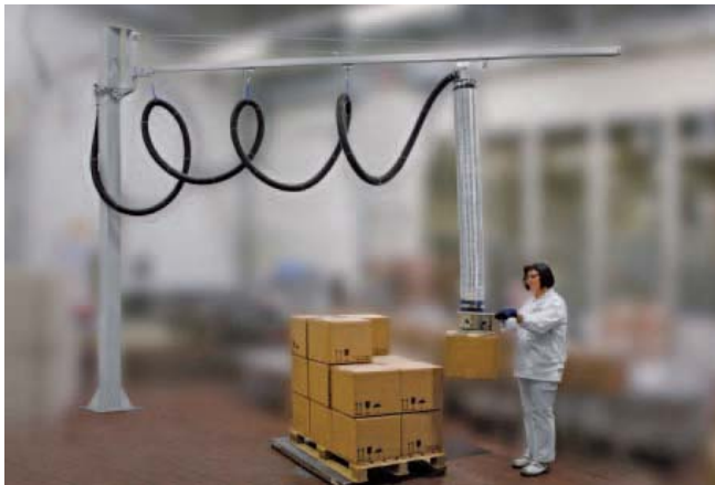
立柱悬臂式轨道系统，配有不锈钢轨道，用于防爆区域，负载 110 kg，悬臂长 4 m
