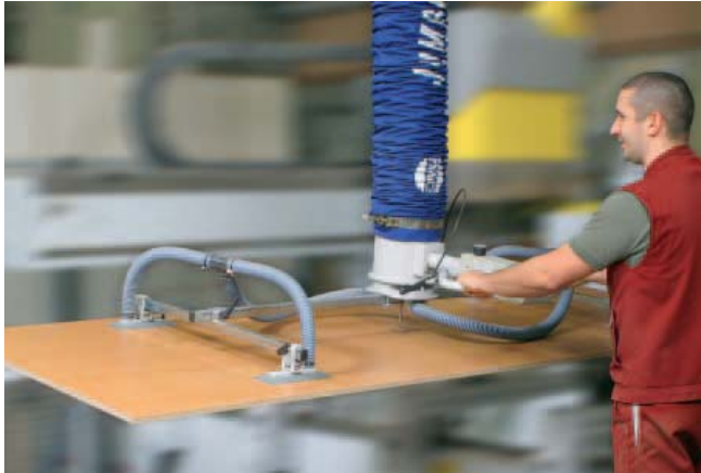
JumboErgo，负载85kg，配有四吸盘组合，用于CNC加工中心的工件上下料
