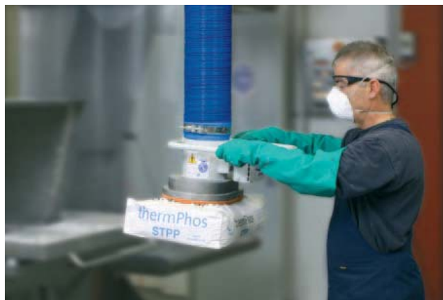
JumboSprint, 负载45 kg, 袋装工件吸盘, 用于搬运塑料袋和纸袋包装
