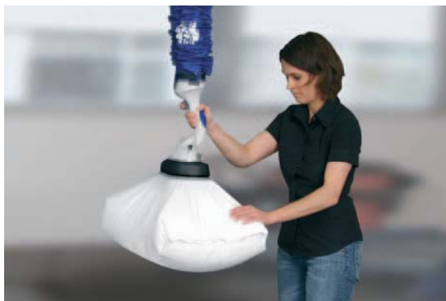
JumboFlex，负载25kg，配有袋装工件吸盘，用于袋类包装
