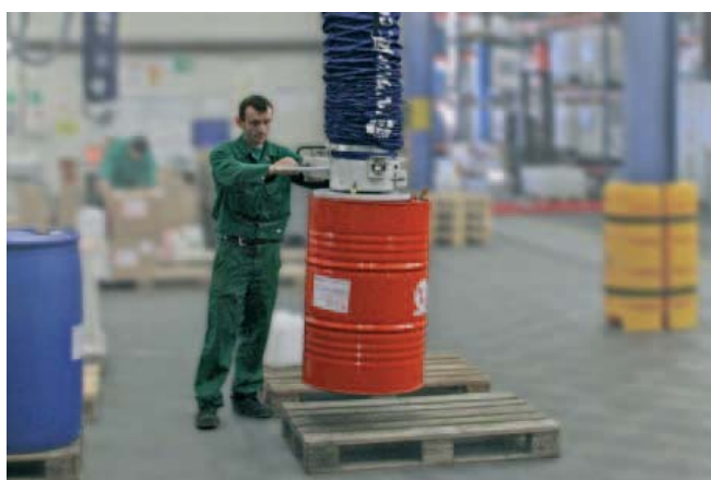
JumboErgo, 负载300 kg, 圆形吸盘, 用于搬运化工桶
