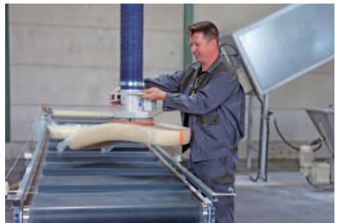
JumboSprint, 负载65kg, 可快速搬运变形橡胶块
