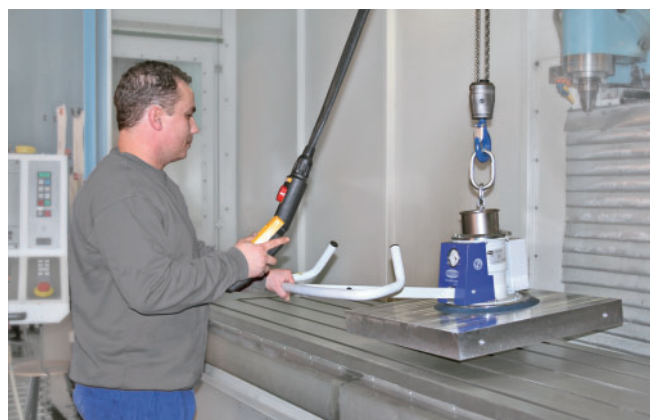
VacuMaster Eco，无动力操控，用于搬运金属部件
