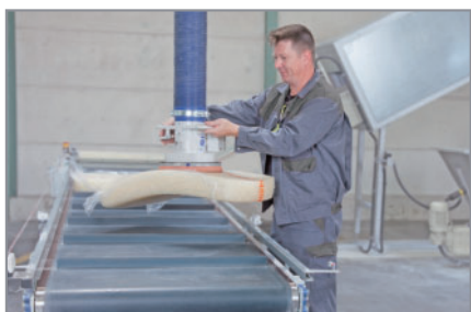
真空管吊具 JumboSprint，应用于搬运橡胶块
