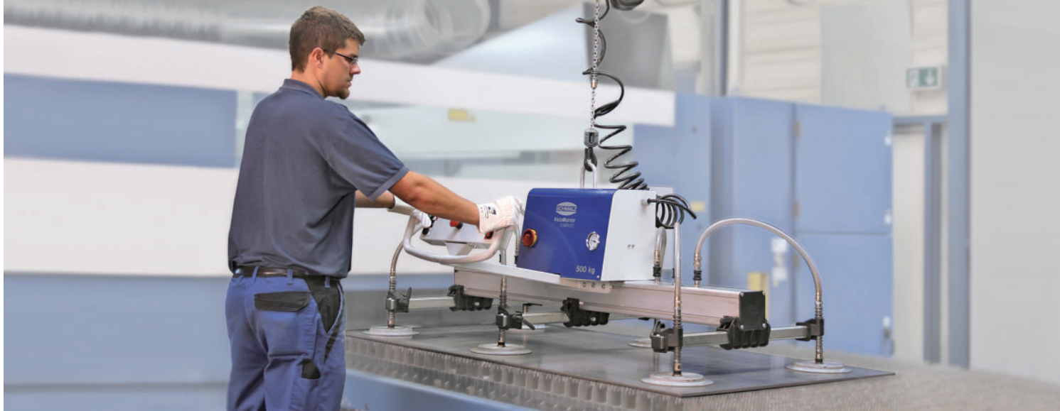
真空起重机 VacuMaster Comfort 为激光切割机上料
