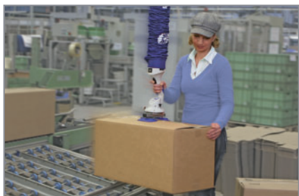
真空管吊具 JumboFlex，应用于搬运纸箱
