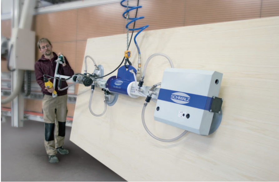
VacuMaster HHVM 应用于吸取垂直存储架上摆放着的木板
