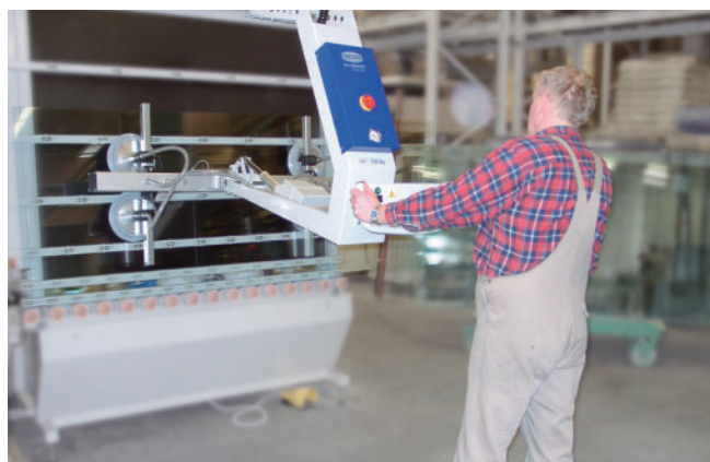
VacuMaster Window (高端型)，用于搬运并 180° 翻转玻璃板
