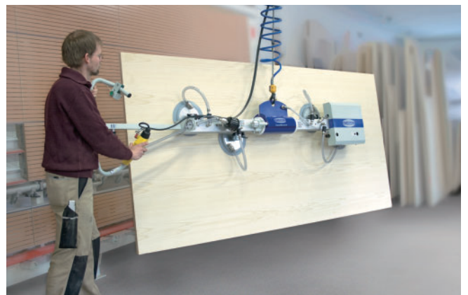
VacuMaster HHVM，可手动向两边翻转 90°，用于为立式电子开料锯上料
