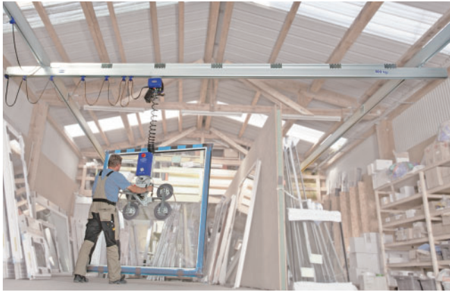
铝合金轨道系统 SRA 配有环链电动葫芦及真空起重机 VacuMaster
