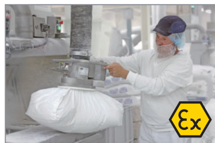
真空管吊具 JumboSprint，防爆等级，应用于搬运粉袋
