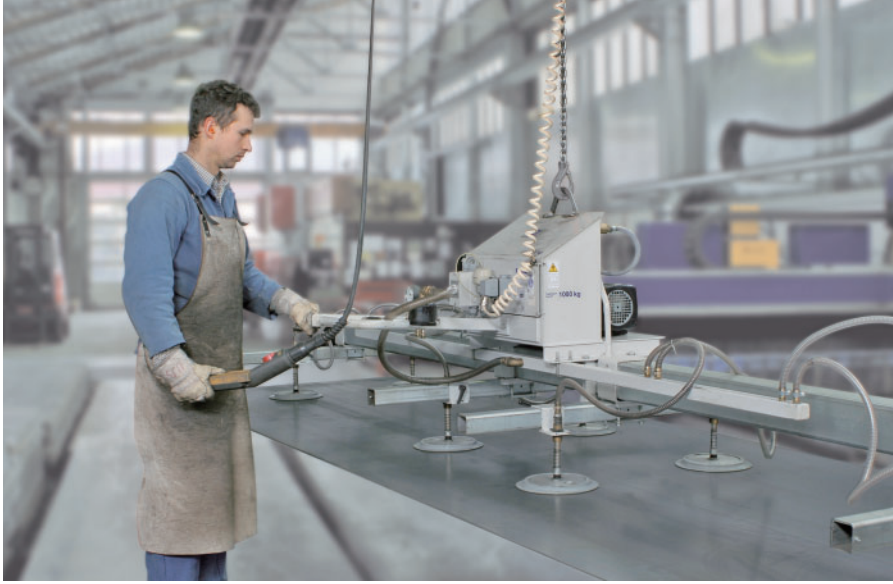
真空起重机 VacuMaster Vario 应用于为激光切割机上下料
