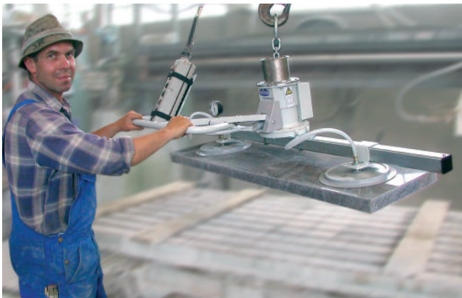
石材 | VacuMaster Eco，水平搬运，用于为石材加工设备上下料
