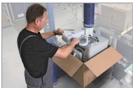
真空管吊具 JumboErgo，应用于产品装箱及纸箱搬运
