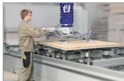
真空管吊具 JumboErgo，应用于 CNC 机床上料
