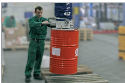
真空管吊具 JumboErgo，应用于搬运化工桶
