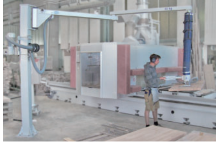
铰链式悬臂 附加摆动关节，可避开障碍物
