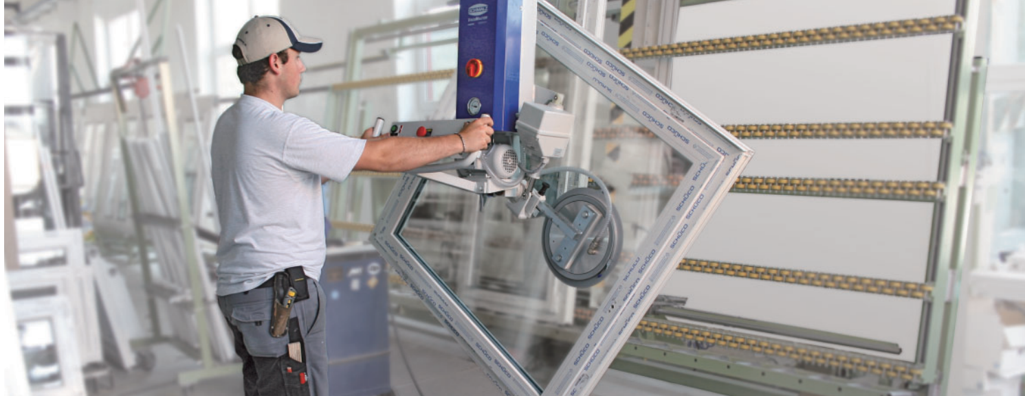
真空起重机 VacuMaster Window (高端型) 用于为压机上下料
