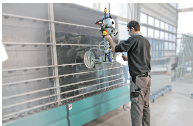
VacuMaster Window，用于在清洗设备中玻璃板的垂直搬运
