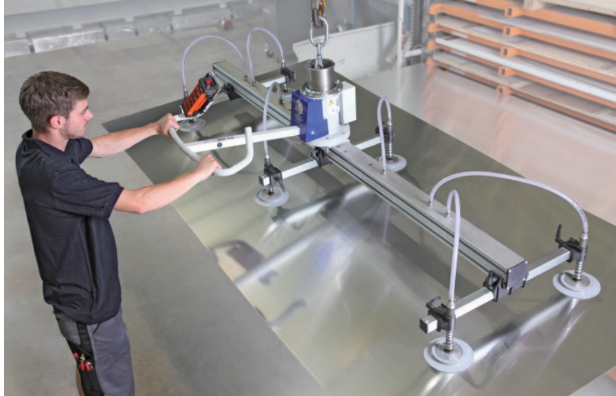
VacuMaster Eco 用于从抽屉式货架中搬运金属板
