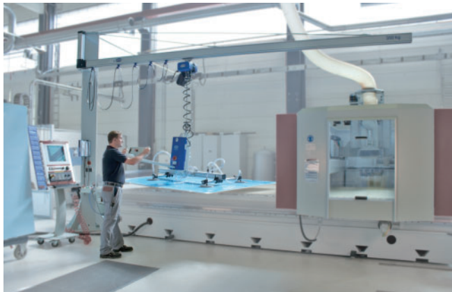
立柱悬臂轨道 SK，配有环链电动葫芦和真空起重机 VacuMaster
