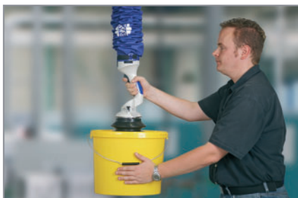
真空管吊具 JumboFlex，应用于搬运化工桶
