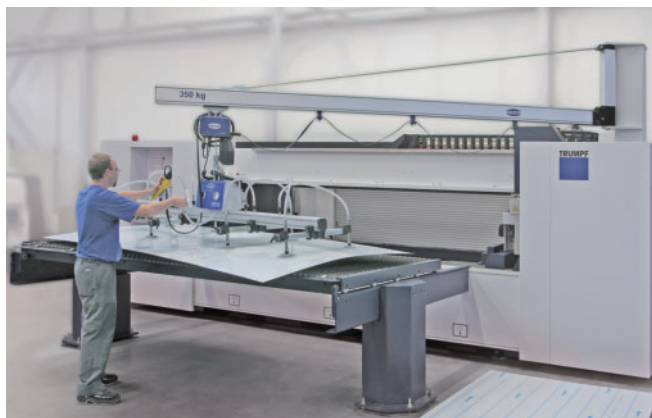
通快 TruLaser 1030 激光切割机一体式安装解决方案：VacuMaster Basic 和挂式悬臂轨道系统
