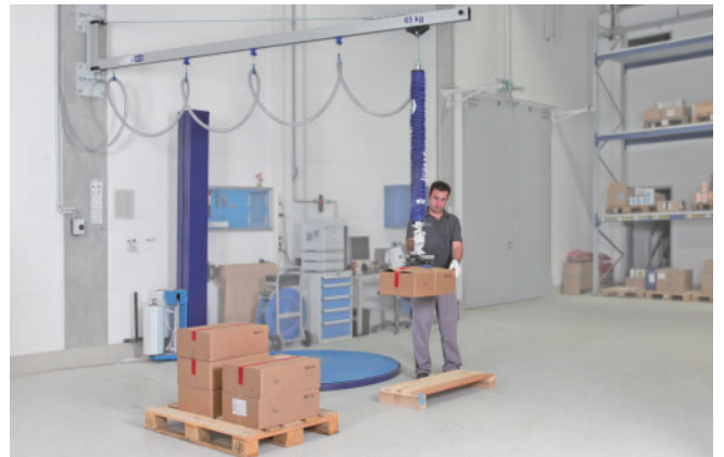
墙挂悬臂轨道 WK，配有真空管吊具 Jumbo
