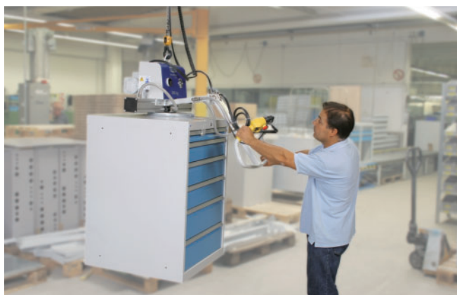
仓储设备 | VacuMaster Basic, 配有弯曲手柄, 应用于搬运重型工具柜
