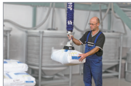
真空管吊具 JumboFlex，应用于搬运粉袋
