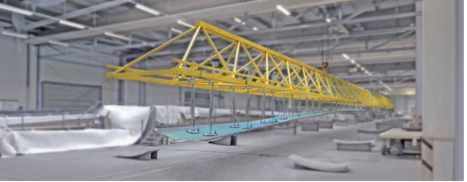
风能 | 真空起重机 VacuMaster 应用于搬运重达数吨、长达 60 米的风车叶片
