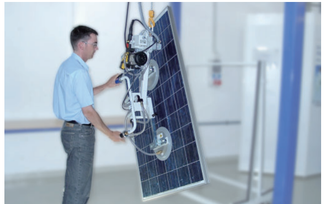
光伏 | VacuMaster Window，用于垂直搬运光伏组件
