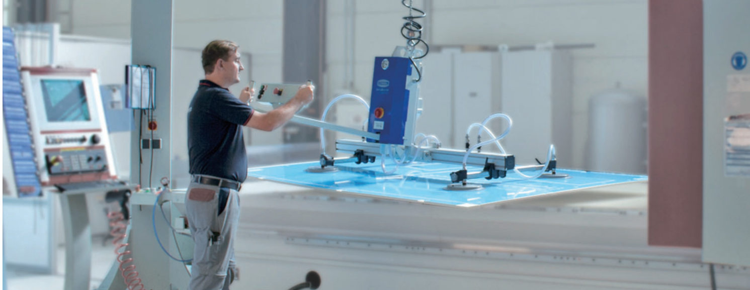
塑料 | 真空起重机 VacuMaster Comfort, 可 90° 翻转, 用于搬运塑料板
