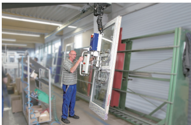
VacuMaster Window (高端型)，用于垂直搬运中空玻璃窗
